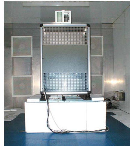
Bild 2: Luft/Wasser Wärmepumpe in Splitausführung Außengerät
